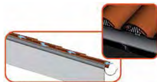
Entrada d'aire a través de la pinta del ràfec
